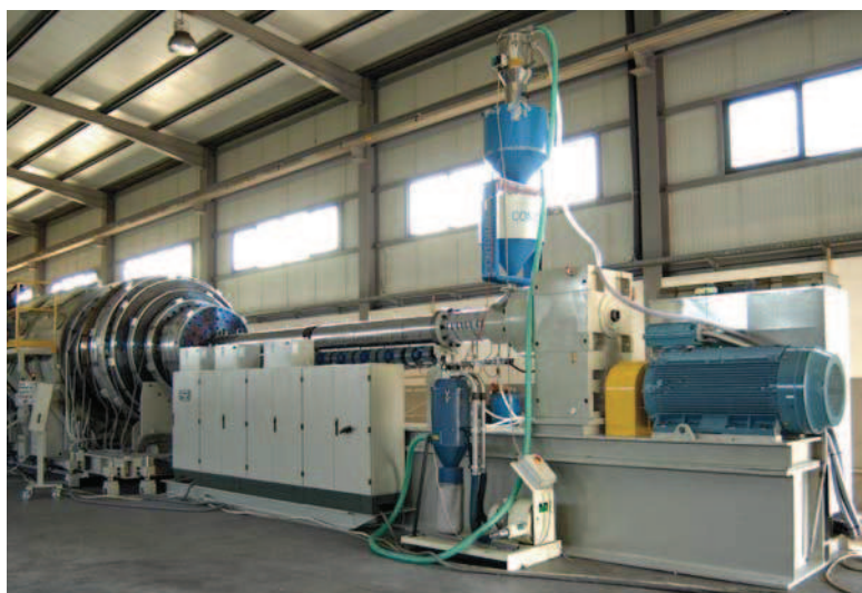
CONTGRAV instalado numa extrusora Periplast, fabricante nacional de equipamentos para extrusão de tubo.
